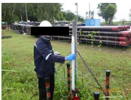
บ่อเจาะสำรวจคุณภาพน้ำใต้ดิน ณ ค่ายพักผู้ปฏิบัติงาน (GW1)
